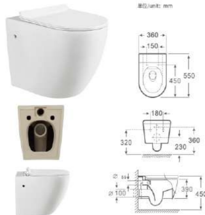
型号/Model FT-135 品名/Product Name 对冲式挂墙座便器 Collision type flush wall-hung closet 尺寸/Size 550 x 360 x 390mm 横排污距离/P-trap 180mm
